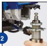
2 Ouvrir le clapet et retirer la pompe
