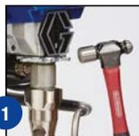
1 Desserrer l'écrou de serrage.
